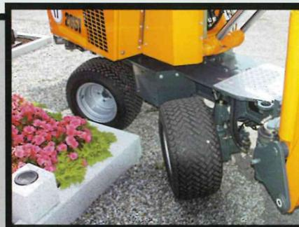
**PROFESSIONELL.** Der BOKI-Mobilbagger Typ 2651 überzeugt durch seine Reichweite, die ein einfaches Baggern in der 2. Grabreihe ermöglicht. Die Sekundärabsicherung des Hubarms verhindert zuverlässig eine Überbeanspruchung des Auslegers.
