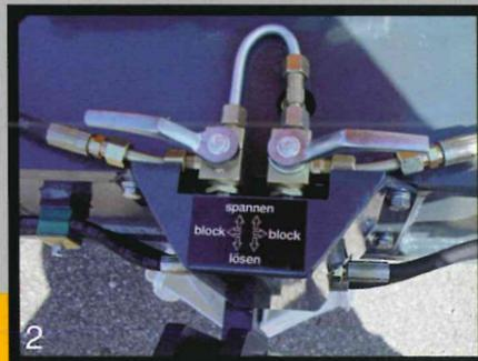
Durch die besonders robuste und unendlich verstellbare Abstütztechnik (Abb. 1) ist eine hohe Standsicherheit des Baggers gewährleistet. Mit leicht zu betätigenden hydraulischen Verriegelungen können die FüÙe millimetergenau platziert werden (Abb. 2). Die hintere Stützfußsteuerung kann sowohl von der Kabine aus als auch heckseitig von außen (Abb. 3) erfolgen.
